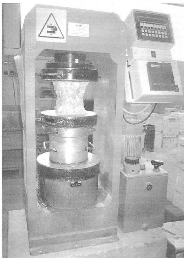
Prova di compressione su CALCESTRUZZO
