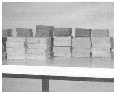
Campioni di terra sottoposti a Prova di taglio
