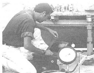
Prova di portanza su piastra
